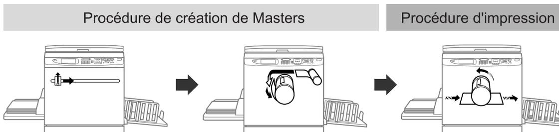
L'original est scanné par le scanner, puis un Master est créé et enroulé autour du tambour d'impression. Après un certain temps, une copie d'essai est imprimée. Après avoir vérifié le résultat de l'impression, entrez le nombre de copies à imprimer et démarrez l'impression.
