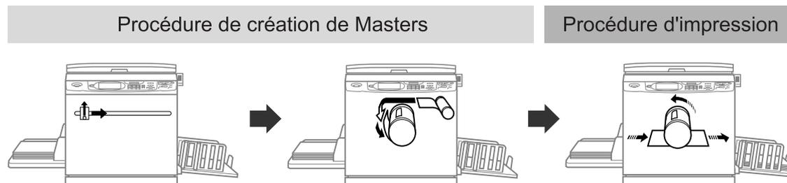
L'original est scanné par le scanner, puis un master est créé et enroulé autour du tambour. Après un certain temps, une copie d'essai est imprimée. Après avoir vérifié le résultat de l'impression, saisissez le nombre de copies à imprimer et démarrez l'impression.
