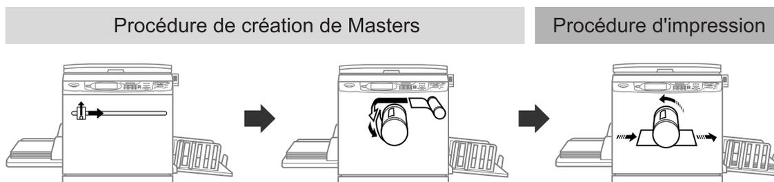
L'original est scanné par le scanner, puis un Master est créé et enroulé autour du tambour d'impression. Après un certain temps, une copie d'essai est imprimée. Après avoir vérifié le résultat de l'impression, saisissez le nombre de copies à imprimer et démarrez l'impression.
