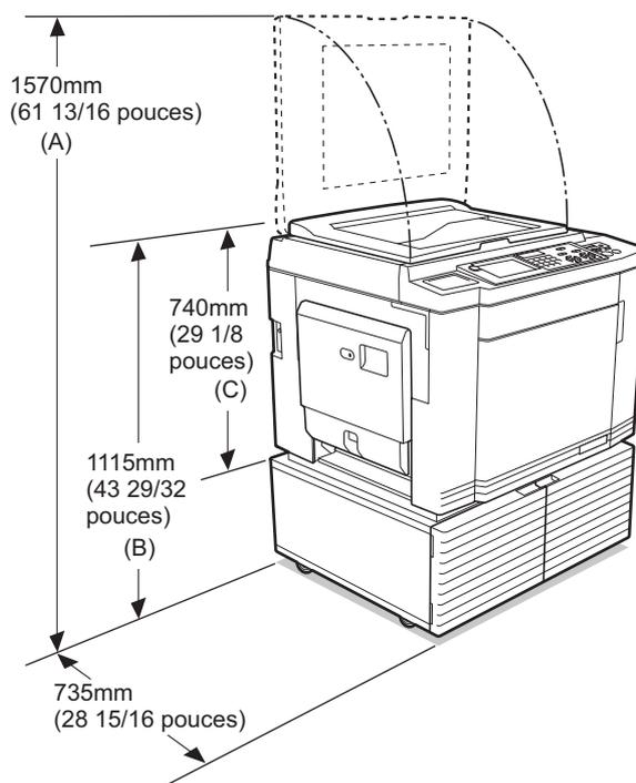
Quand l'alimentateur automatique de documents optionnel est installé, les valeurs de (A) à (C) de la figure ci-dessus sont les suivantes.
