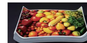
Les encres à base d'eau sont sujettes à des déformations telles que l'ondulation et le tuitage.
